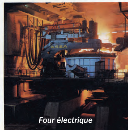
Fig. 1. Four à arc moderne avec voûte pivotante et basculement hydraulique.
